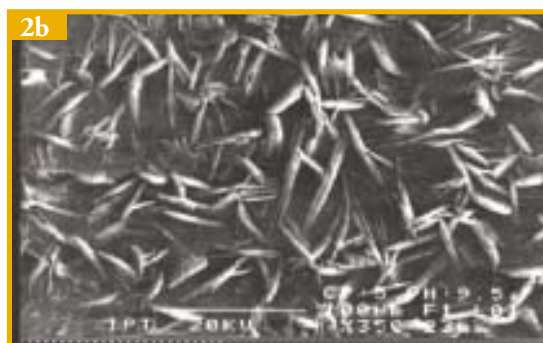
Figura 2 – Efeito da introdução do estágio de condicionamento no tamanho de cristais de fosfato em substratos de aço carbono laminado a frio (banho à base de fosato de zinco acelerado com nitrato e nitrito). Na figura 2a, é mostrada a morfologia da camada de fosfato obtida sem o estágio de condicionamento e na figura 2b com o estágio de condicionamento (Aumento 350 x)
