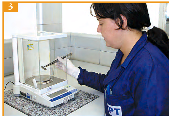
Fig. 3 - Execução de ensaio de perda de massa
