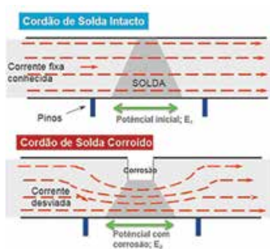
Figura 4 - Variação de campo elétrico em um cordão de solda com corrosão.
