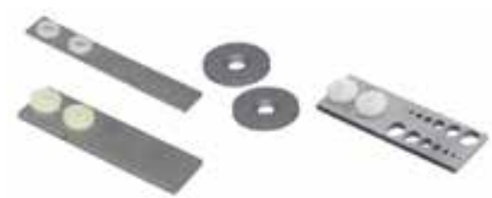
Figura 1 - Diferentes tipos de cupons de perda de massa da marca Emerson.
